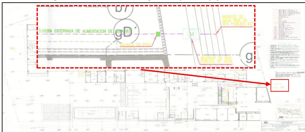
Imagen n.º 4 Ingreso del abastecimiento del agua al Hospital de Apoyo de Otuzco
